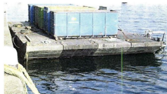
Figure 24 : Transport de sédiments vers la centrale : un ponton transportant des bennes étanches vers l'unité de traitement
