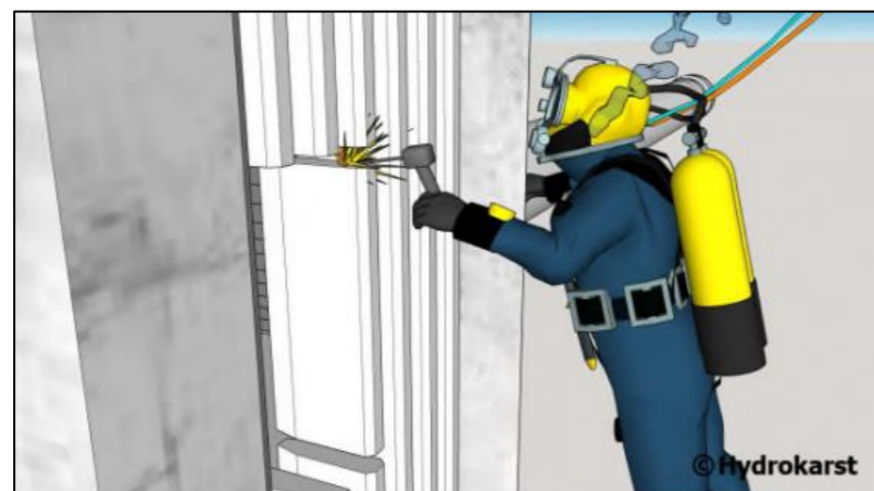
Figure 15 : Illustration du découpage des armatures par oxy-arc – Source : Hydrokarst
